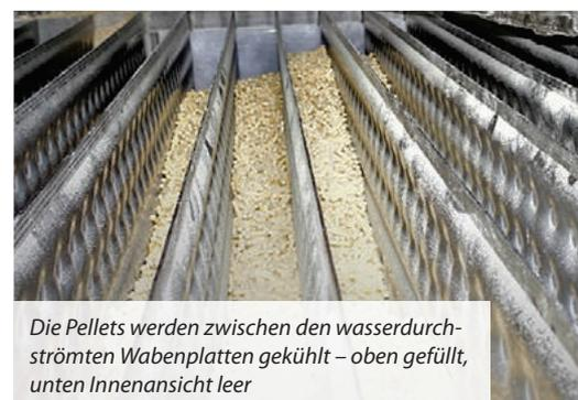
Die Pellets werden zwischen den wasserdurchströmten Wabenplatten gekühlt – oben gefüllt, unten Innenansicht leer
